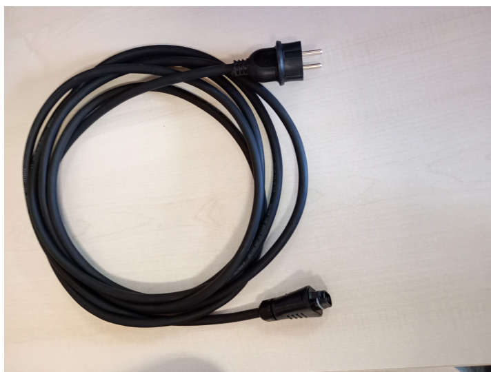
Cavo di collegamento Inverter presa dedicata – lunghezza 3 o 5 metri cavo tipo H07RN-F 3x1,5 mm 2 - con Spina tipo Scuko e connettore femmina allaccio inverter
