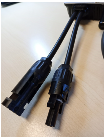
Connettori tipo MC4 (input DC) per collegamento pannello fotovoltaico a Micro Inverter
