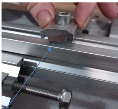
martelletti per fissaggio Pannello a struttura (n. 4 pezzi)
